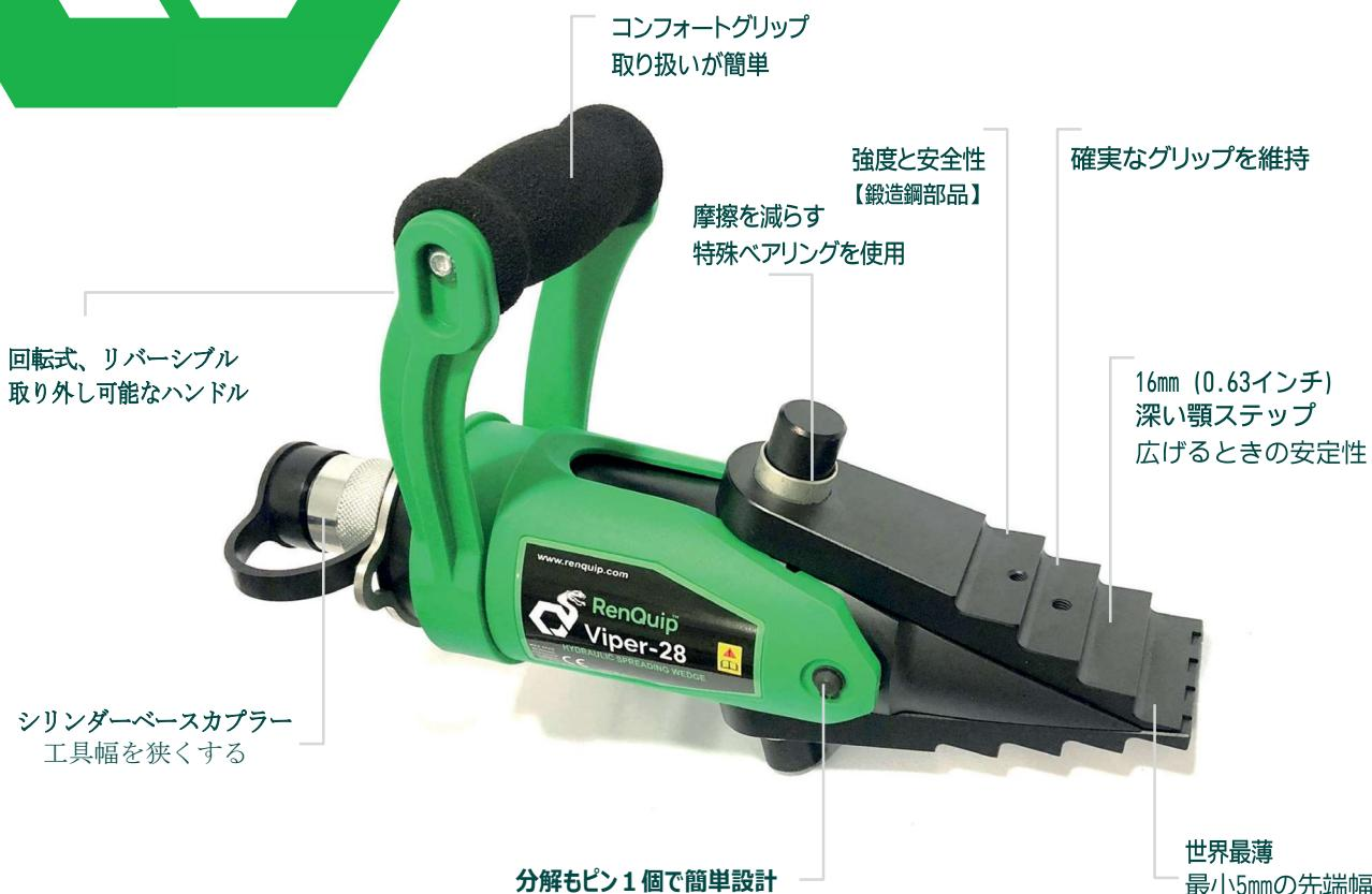
Viper-28 Kは、RenQuipの最新の革新的なフランジスプレッダーで、5mmのアクセスギヤップに入り、ツールごとに277kN(27.7T)の荷重を生み出することができます。
